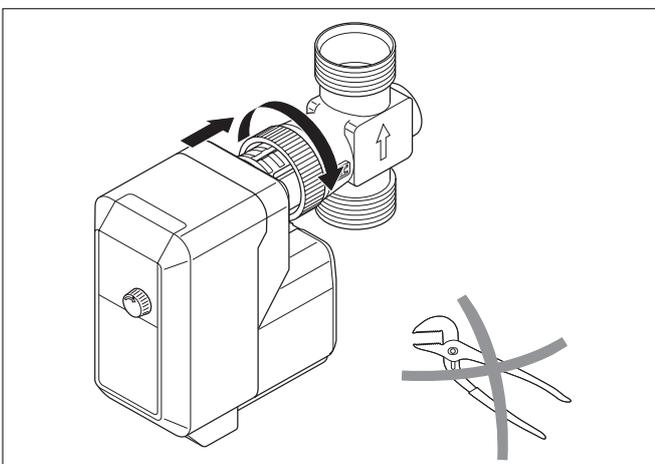
Рис. 3. Установка привода
