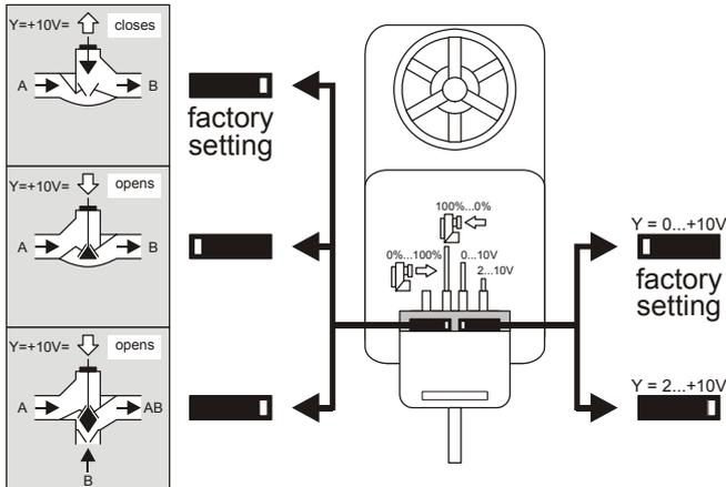
Рис. 4. Выбор типа клапана и выходного сигнала
