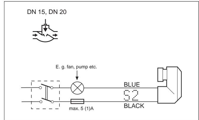
Рис. 11. Подключение вспомогательного переключателя
