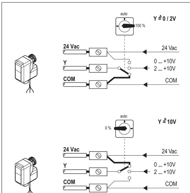
Рис. 5. Подключение входного переключателя
