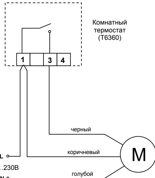
В случае обесточивания, клапан остается в положении на момент отключения электричества. После восстановления питания клапан будет реагировать на команды реле.
