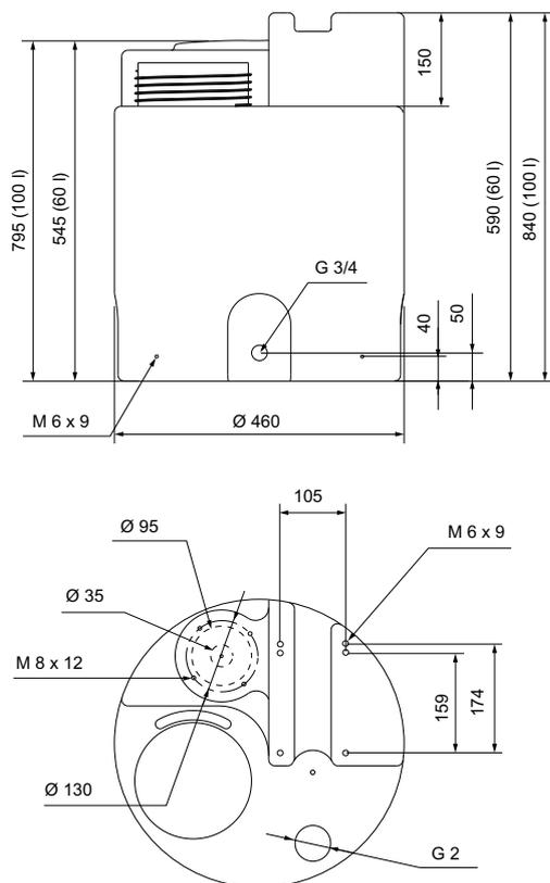
Рис. 50 Цилиндрический бак на 60 и 100 литров
