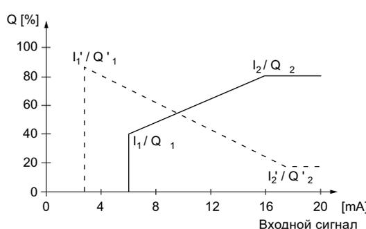
Рис. 11 Зависимость расхода дозирования от внешнего аналогового сигнала
