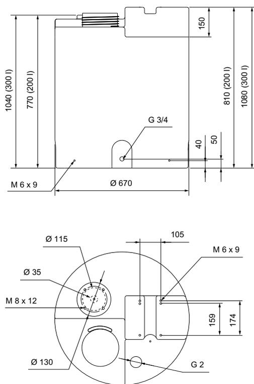
Рис. 51 Цилиндрический бак на 200 и 300 литров
