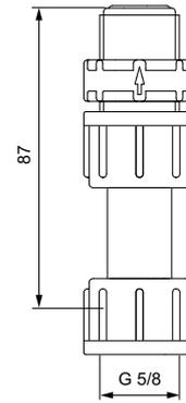
Рис. 44 Нагнетательный клапан
