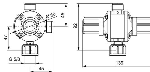
Рис. 41 Многофункциональный клапан
